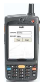
Abb.: Handheld als Fernbedienung für das Bremsprobengerät
