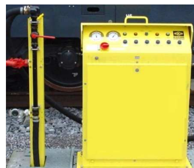
Abb.: Schlauchhalter und Bremsprobengerät
