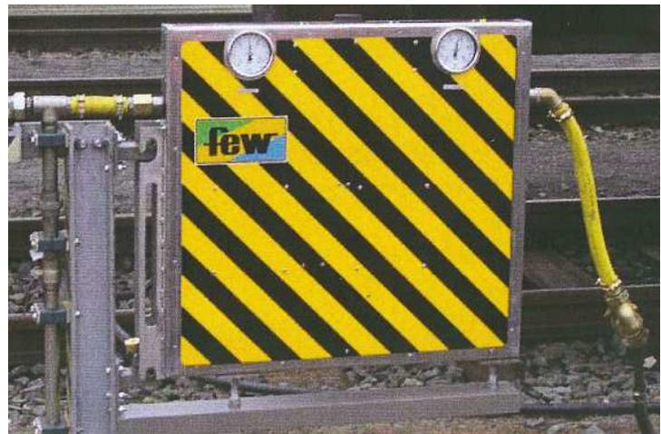
Bremsprobengerät der Firma Knorr-Bremse und der Firma FEW
